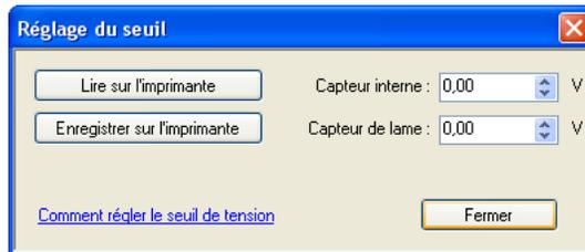
4 Pour lire les valeurs du capteur interne et du capteur de lame sur l'imprimante et régler les commandes du **Capteur interne** et du **Capteur de lame** en conséquence, sélectionnez **Lire sur l'imprimante**.
