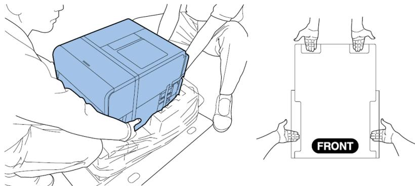
**Note:** L'imprimante pèse approximativement 24 kilos (53 livres). Deux personnes sont nécessaires pour la soulever. Les deux personnes, positionnées respectivement devant et derrière l'imprimante, doivent la soulever en plaçant les mains sous les poignées inférieures (deux à l'avant, une à gauche et une à droite). Si la position est mauvaise lorsque vous tentez de soulever l'imprimante, celle-ci risque de tomber ou d'occasionner des blessures.
