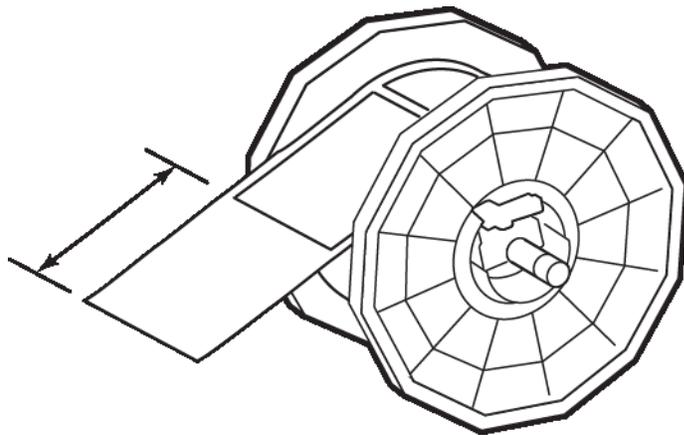
Ce processus permet d'améliorer la précision du capteur en permettant de faire avancer une petite partie du liner d'étiquettes dans l'imprimante avant d'introduire le support.
