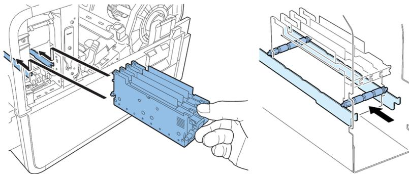
Si la tête d'impression n'est pas suffisamment insérée, vous ne pourrez pas fermer le levier de dégagement inférieur de la tête d'impression. Pour vous assurer que la tête d'impression est bien positionnée, vérifiez que l'extrémité de la poignée de la tête d'impression et le bord de la plaque métallique inférieure sont alignés comme indiqué sur l'illustration.
