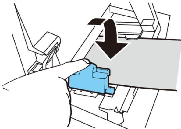
**17** Empuje lentamente la guía de papel hacia abajo hasta que haga un clic (se asegure). Cuando se asegure, el material será transportado automáticamente.
