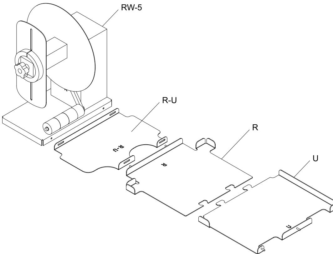
**3** Inserte las pestañas del soporte U dentro de las ranuras del soporte R. Estos dos soportes serán usados más tarde para colocar la impresora Kiaro!
