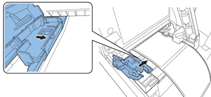
**Nota:** No presione la guía de transporte (derecha) fuertemente contra el borde del material porque se puede producir un atasco.
