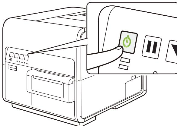
Se realiza una limpieza y la impresora estará lista para imprimir. Cuando la impresora está en el modo Encendido, la LED de ESTATUS se mantiene encendida.
