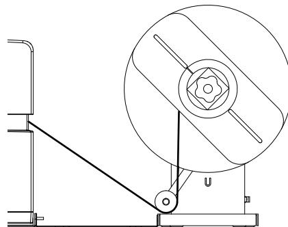
A medida que el brazo oscilante se levanta, el mandril desenrollará y cargará el material necesario. No gire a mano el mandril del desenrollador para avanzar el material. Si necesita avanzar el material, levante un poco el brazo oscilante.
