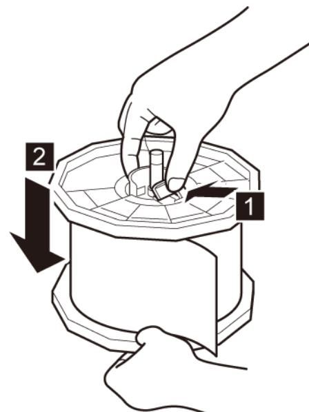
Suelte la palanca de desenganche del tope del soporte.
