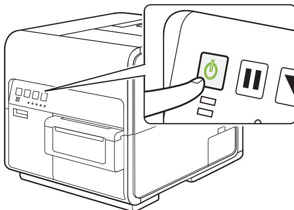
La LED de encendido parpadea a intervalos largos, y luego la impresora se apaga.
