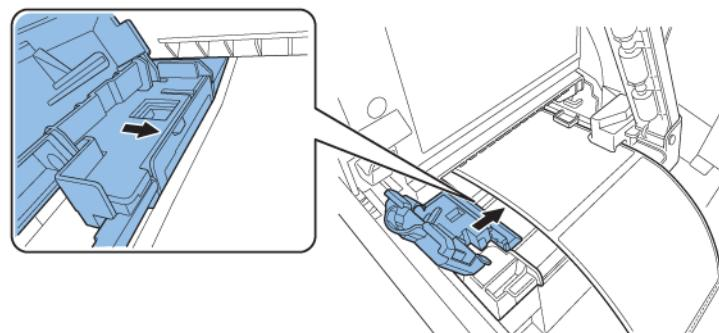
**Nota:** No presione la guía de transporte (derecha) fuertemente contra el borde del material porque se puede producir un atasco.
