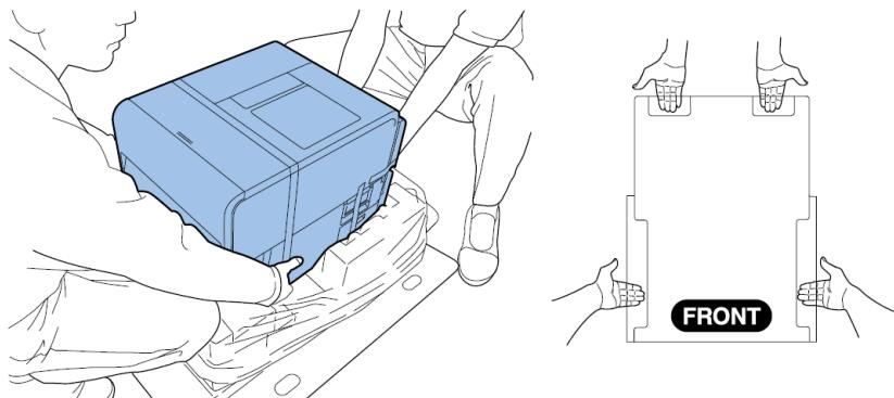
**Nota:** La impresora pesa unas 53 libras (24 kilogramos). Se necesitan dos personas para levantar la impresora. Dos personas de pie, una frente a la impresora y la otra detrás de la misma deben levantar la impresora sosteniéndola con las manos por debajo de las manijas inferiores (dos por el frente, una a la izquierda y una a la derecha). Tratar de levantar la impresora de forma incorrecta puede provocar su caída o una lesión.
