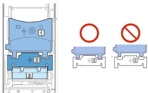
Si alguno de los números (1), (2), o (3) son invisibles, la palanca de desenganche del cabezal de impresión (1, 2) no se ha cerrado o el limpiador de la cuchilla (3) no se ha montado. Revise el procedimiento del trabajo.
