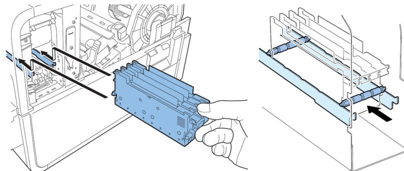
Si el cabezal de impresión no se inserta lo suficiente, la palanca de desenganche inferior no se podrá cerrar. Para asegurarse que el cabezal de impresión esté en la posición correcta, compruebe que el agarre del extremo del cabezal de impresión y el borde de la placa metálica interna están en el mismo plano como se muestra en la figura.
