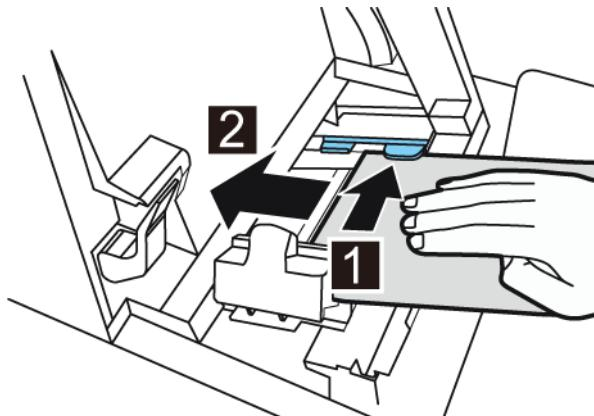
El material del rodillo en la ranura de carga levemente se arrastrará automáticamente.
