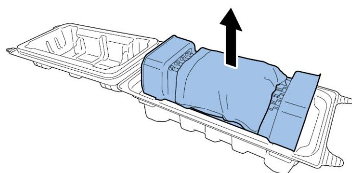
**Precaución:** Para evitar problemas con la inyección de la tinta, no toque la parte frontal del cabezal de impresión. Sujete el cabezal de impresión por la pestaña del extremo solamente.
