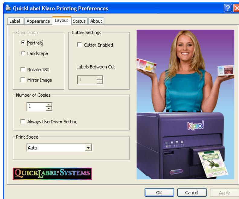
**3** Si es necesario, puede seleccionar la orientación de impresión. La orientación a menudo se establece dentro de la aplicación de diseño. Sin embargo, si no puede seleccionar la orientación en la aplicación de diseño, elija una de las siguientes opciones:
