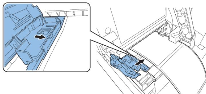
**Nota:** No presione con fuerza la guía de transporte (derecha) contra el borde del material porque se puede producir un atasco.
