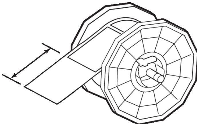
Este proceso mejora la precisión del sensor al permitir que una pequeña porción del soporte de la etiqueta avance por la impresora antes de que se ingrese cualquier material de etiquetas.
